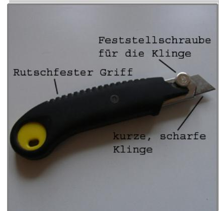
Mit dem Messer können Sie an den Bruchstellen das Teil herausschneiden. Da Holz kein konstantes Material ist, kann es passieren, dass Sie auch die normalen Laserschnitte etwas nachschneiden müssen. Dabei sind meist auf der Rückseite nur einige Holzfasern noch stehengeblieben, die mit wenig Druck durchgeschnitten werden können.
